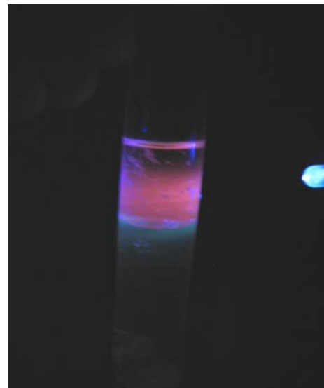
Abb. 13. Die Schicht mit dem Nagellackentferner wird mit UV-Licht bestrahlt und leuchtet rot. (Photo: Helmut Brandl)
