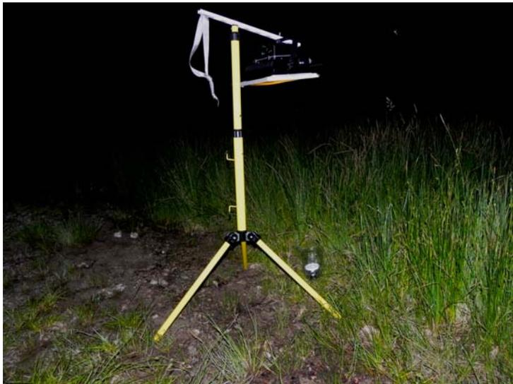
*Abb. 1: Versuchsanordnung mit Leuchte über LED-Falle im Lichtkegel, LED-Falle im Bild am Wegrand rechts vom Lampenstativ.*
